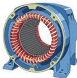
Figure 1.2 : stator d'une MAS
