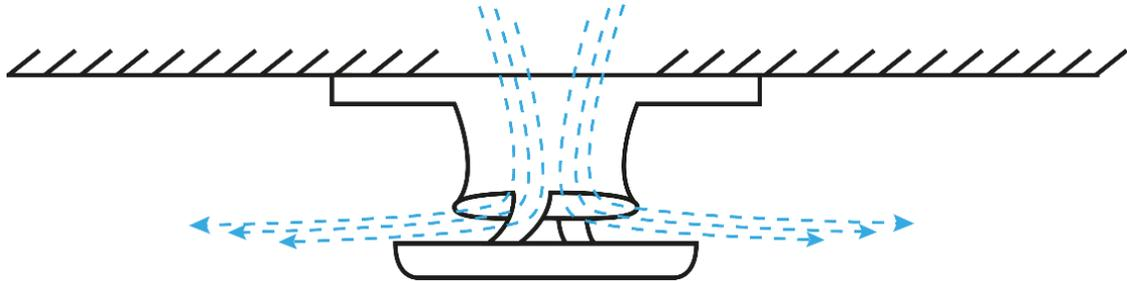
Figure 3.18 : Bouche de soufflage avec diffuseur horizontal
