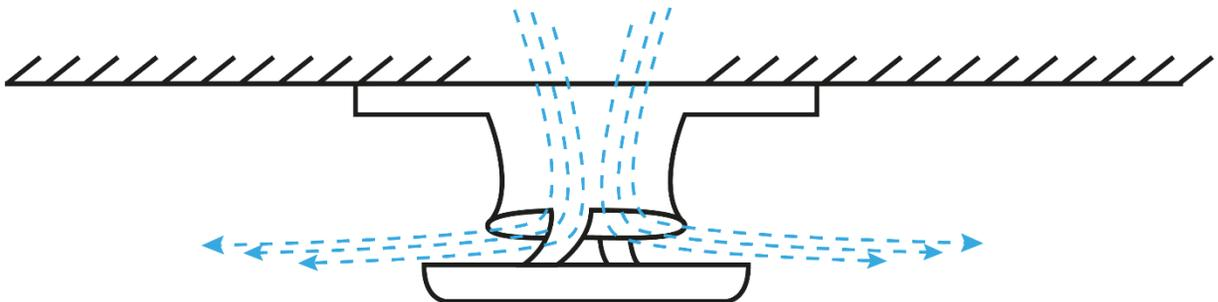
Figure 2.5 : Bouche de soufflage avec diffuseur horizontal
