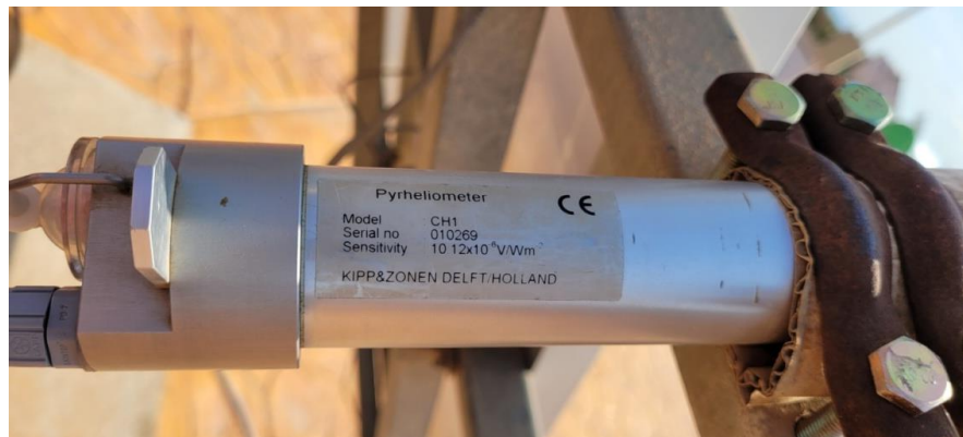
Figure IV.2 : Pyrhéliomètre KIPP & ZONEN CHP1.
