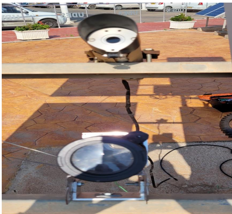
Figure IV.4 : (en haut) le pyrhéliomètre de référence et (en bas) le pyrhéliomètre photovoltaïque.
