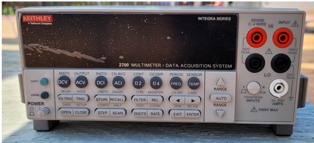
Figure IV.5 : L'appareil KEITHLEY : Le système d'acquisition des données d'éclairage direct, du voltage et de la température.
