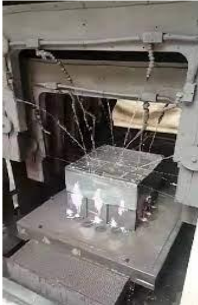
Figure I-18: la découpe de lingot de silicium multi cristallin (AES-CRTSE)
