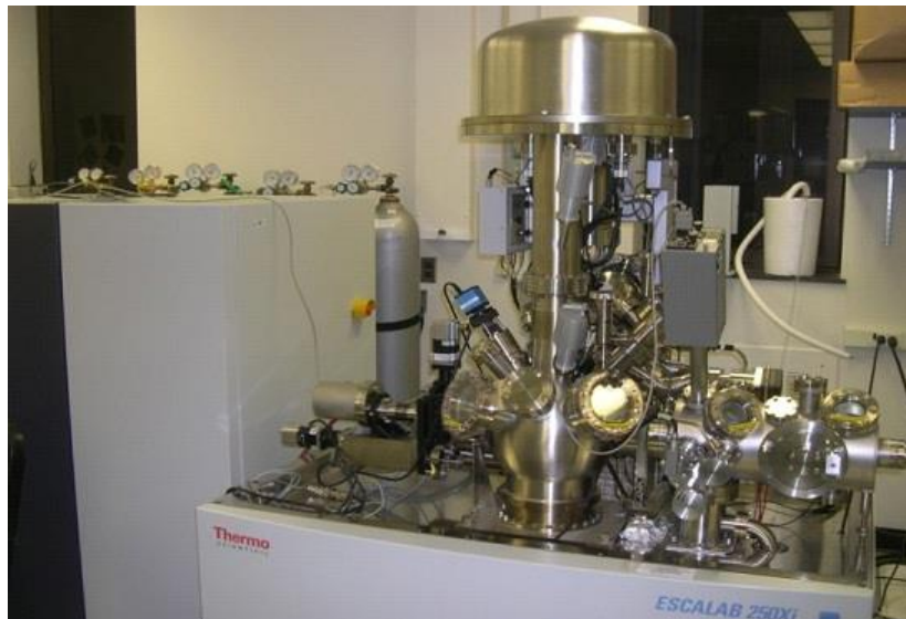
Figure III -36: La spectroscopie de photoélectrons XPS « Escalab 250 Xi » CRTSE
