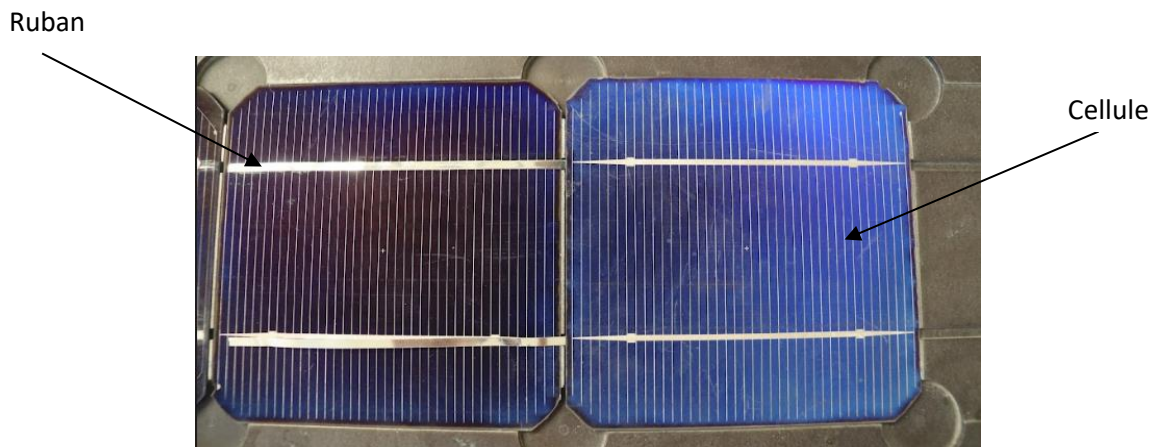
Figure I-22: Câblage des cellules solaires (CRTSE)
