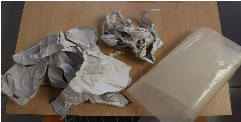
Figure III -30: Les 3 couches tedlar retirés
