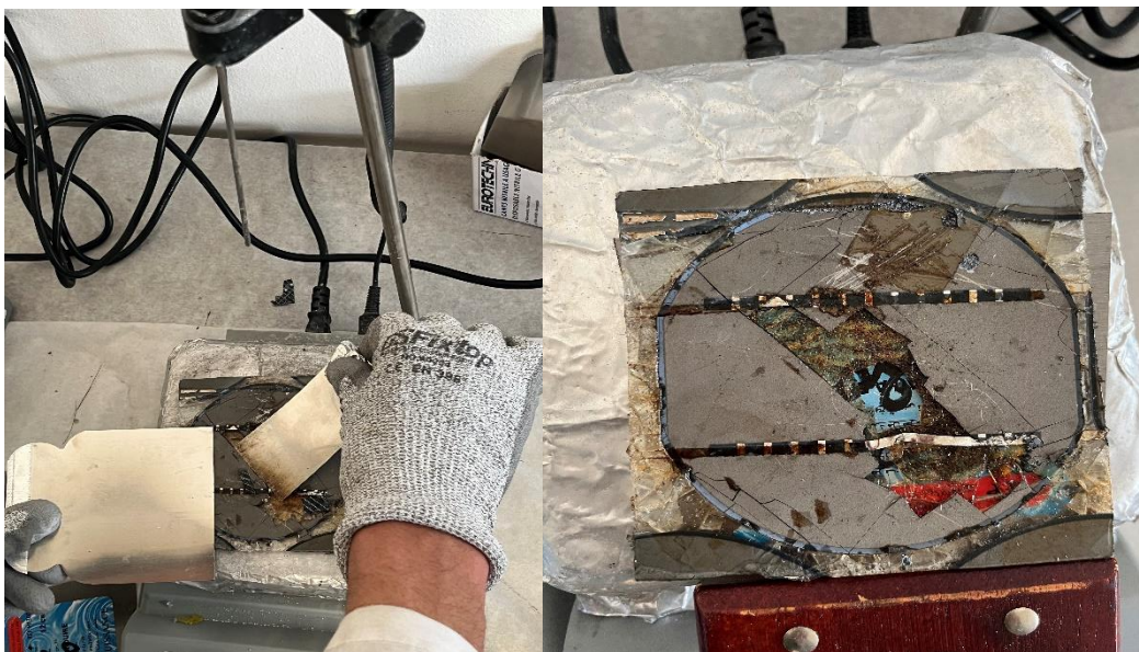
Figure III -32: Echantillon (10×9,7 cm) traité sur a un agitateur thermique à 200°C (CRTSE).
