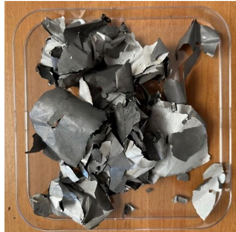
Figure III -27 : L'argent récupéré de la face arrière du traitement chimique (CRTSE).
