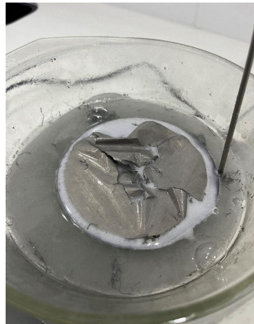
Figure III -44: Argent séparé de la face arrière de la cellule après 8 min
