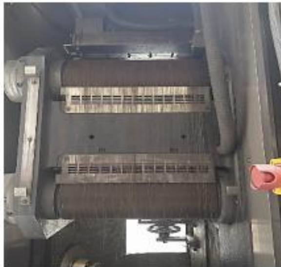
Figure I-19: La toile métallurgique d'une scie utilisée au CRTSE
