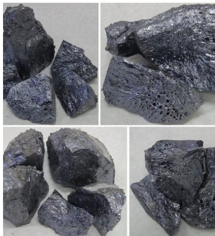
Figure I-8: Le silicium métallurgique (MG-Si) [47]
