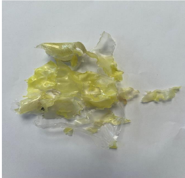
Figure III -10: couche EVA retirés (CRTSE)
