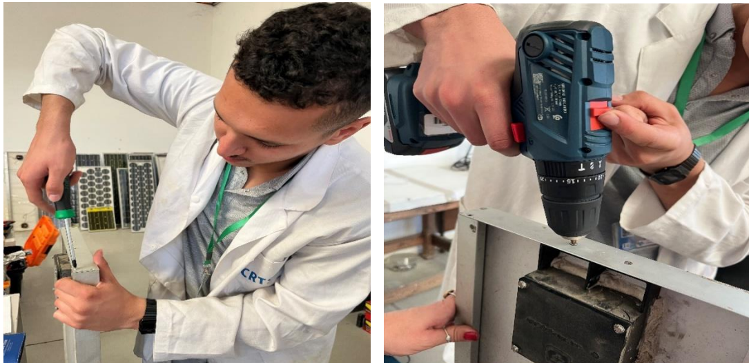
Figure III -5: Démantèlement du cadre aluminium
