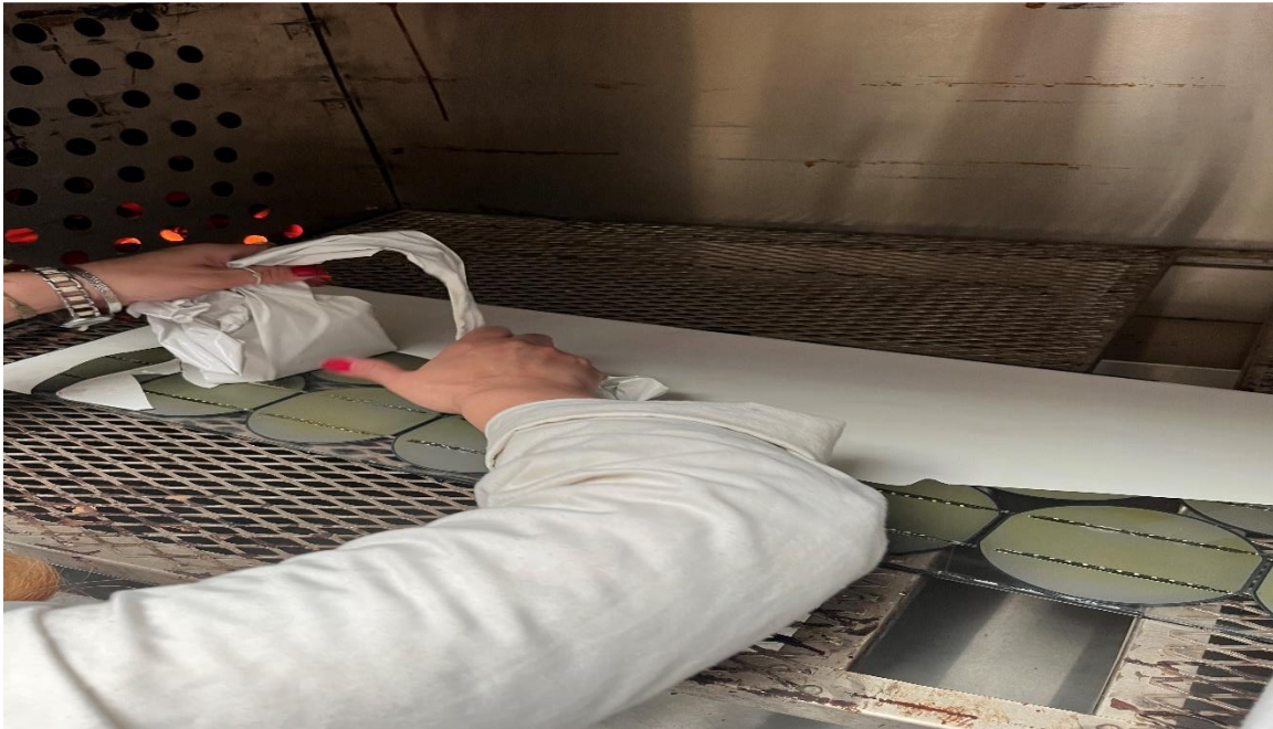
Figure III -8: Séparation de la couche tedlar dans le four monté à 110°C
