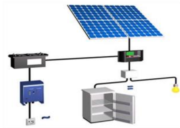
Figure I.10 : schéma d'un system autonome.[10]
