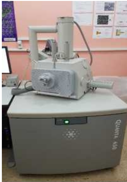
Figure II.5. Appareil MEB couplé avec la spectroscopie EDX.
