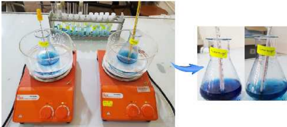
Figure II.6. À gauche : Dispositif expérimental de l'adsorption du BM sur la caroube. À droite : Dégradation de la solution de BM avant et après adsorption.
