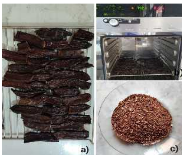
Figure II.1. Processus de préparation du matériau : a) Lavage, b) Séchage et c) Broyage.
