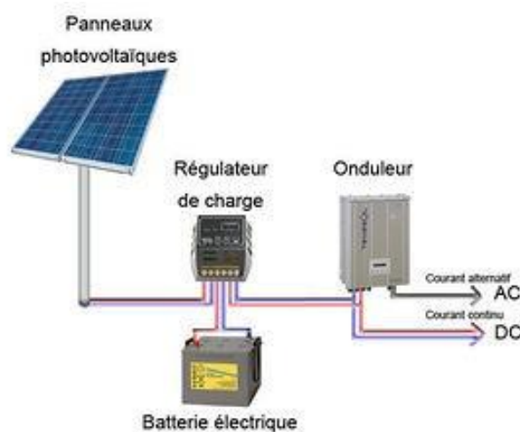
Figure(I.3): Schéma typique d'une installation photovoltaïque autonome. [14]
