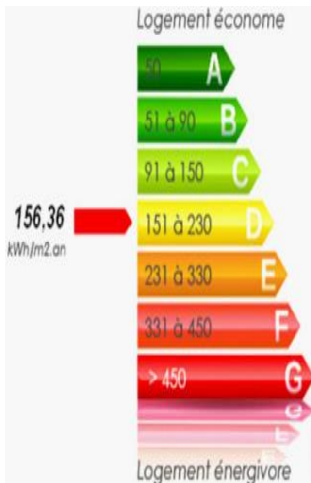
Figure I. 2: Label énergétique européen
