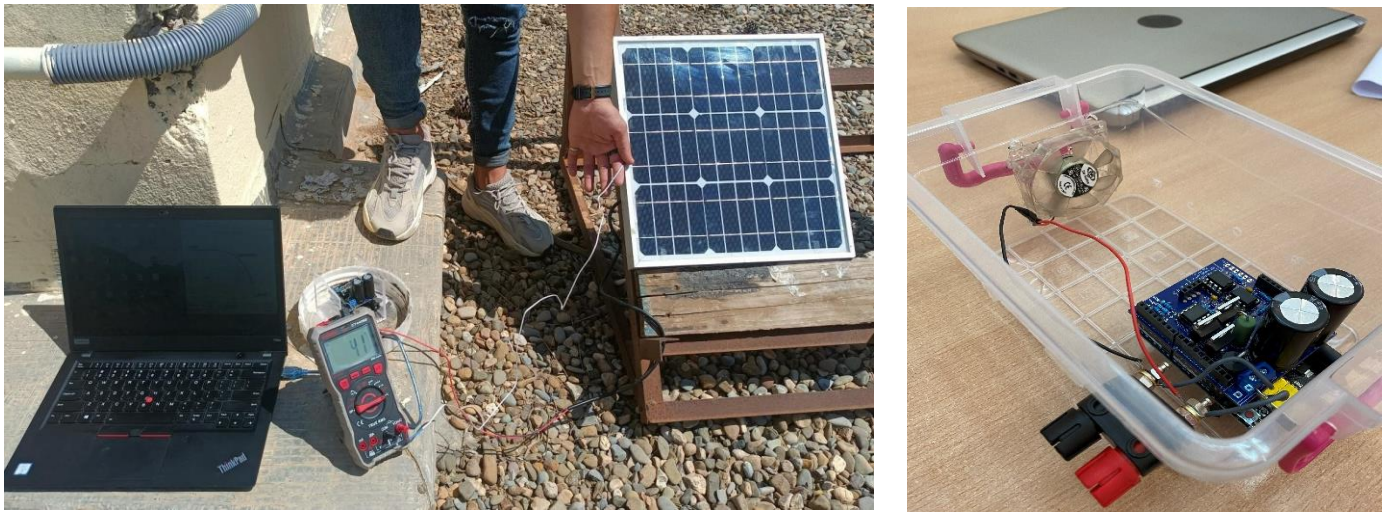
Figure (IV.2) : le traceur et son branchement au module PV N°1.
