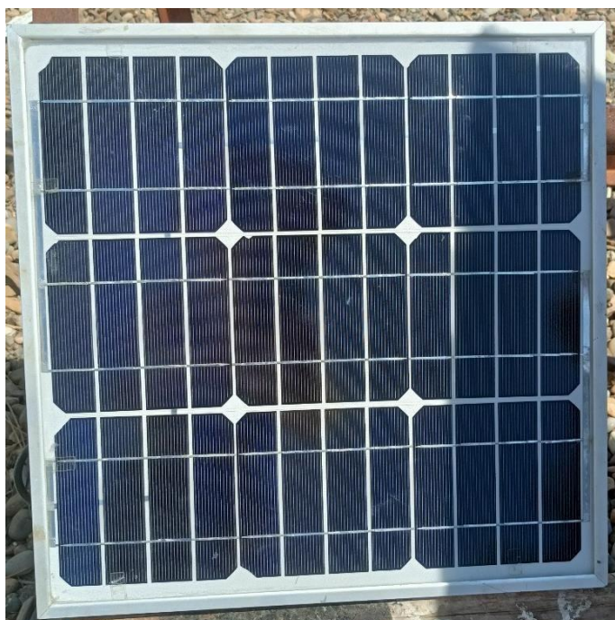
Figure (IV.4) : module PV N°1 sous ombrage.
