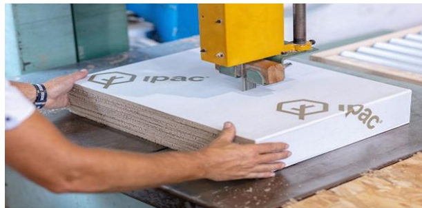
Figure II. 4 : Isolant porteur alvéolaire cellulosé.
