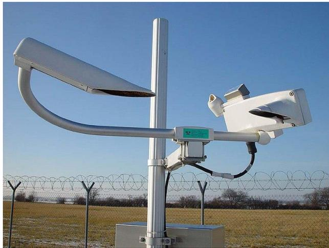
Figure I.2: Diffusomètre [15]
