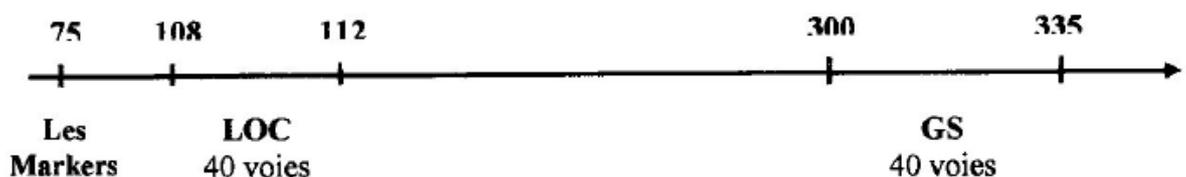
Figure III.8: Plan de fréquence en MHz
