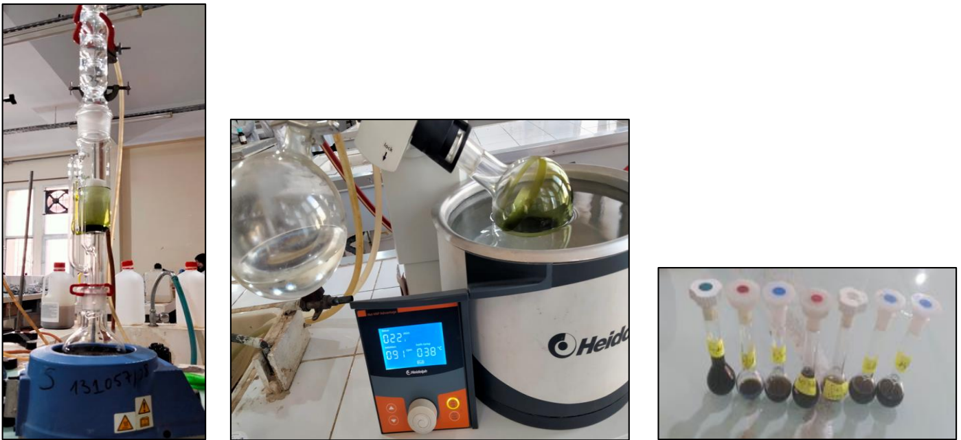
Figure 3 : préparations des extraits par soxhlet.
