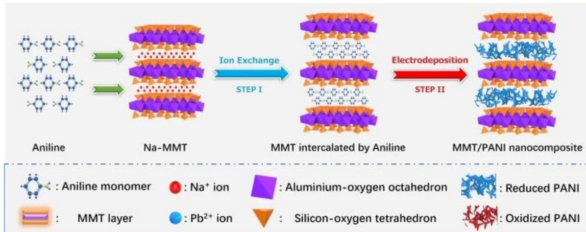
Figure 1.12 : Schéma utilisé pour la préparation des nanocomposites de MMT-Na / PANI
