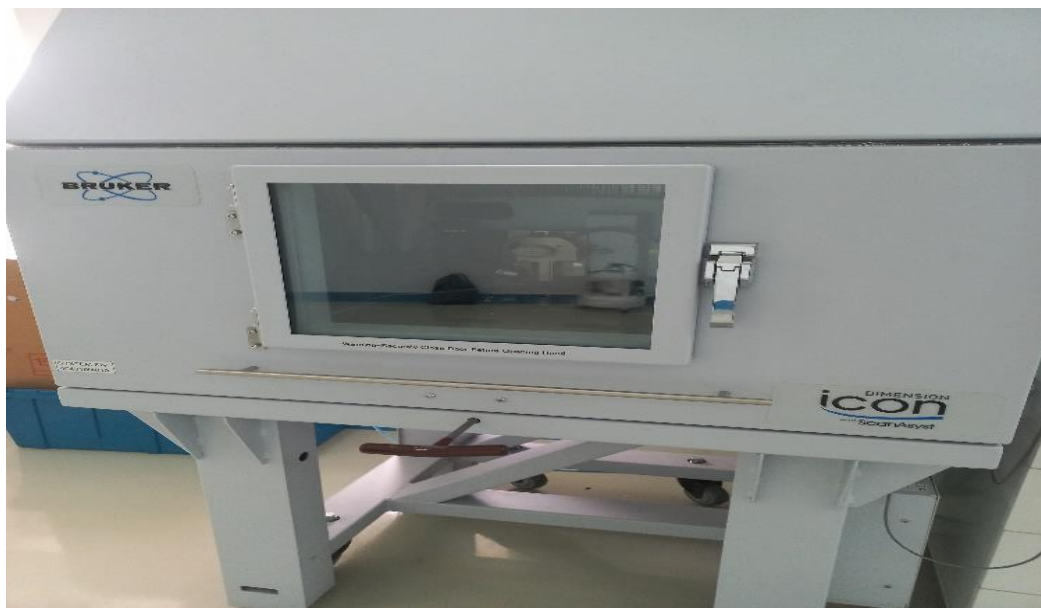
Figure II.8: Photographie du dispositif de l'AFM du plateau technique de l'USTHB
