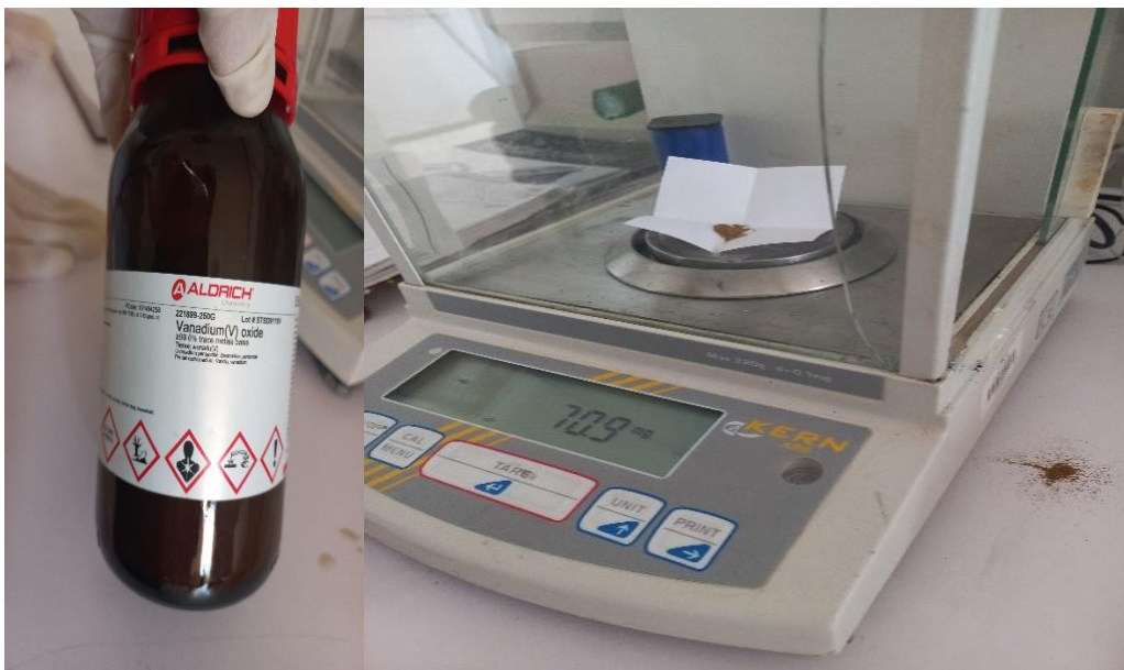
Figure II.3 : Photographie de la poudre de vanadium et de la microbalance au CDTA.
