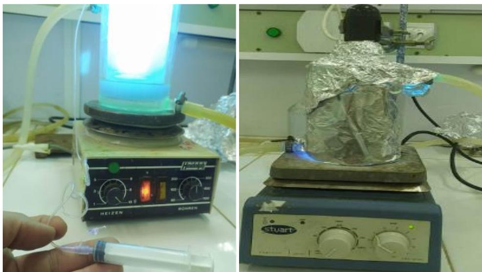
**Figure II.9:**Dégradation du bleu méthylène en milieu aqueux par photocatalyse.
