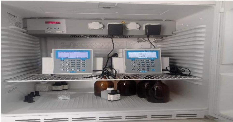
**Figure IV.2:** DBO<sub>5</sub> mètre (Originale ,2023).
