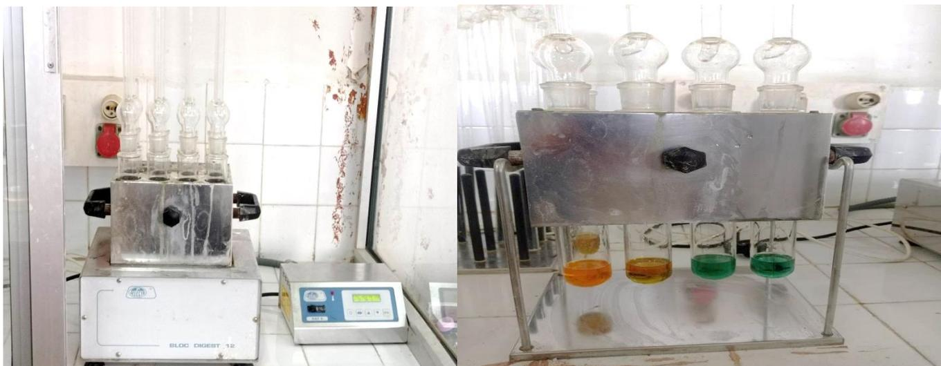
**Figure IV.6 :** Appareil de mesure la DCO ( DCO mètre).
