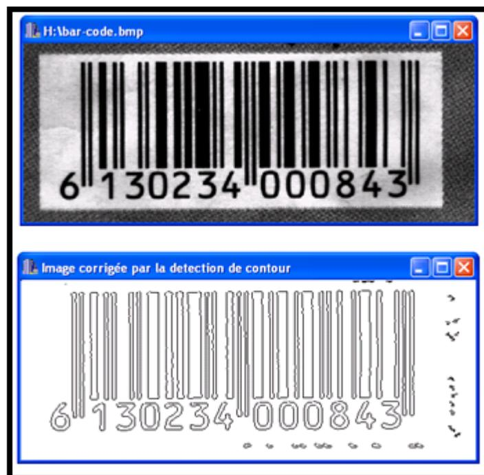
**Figure 1.13** Détection de contour
