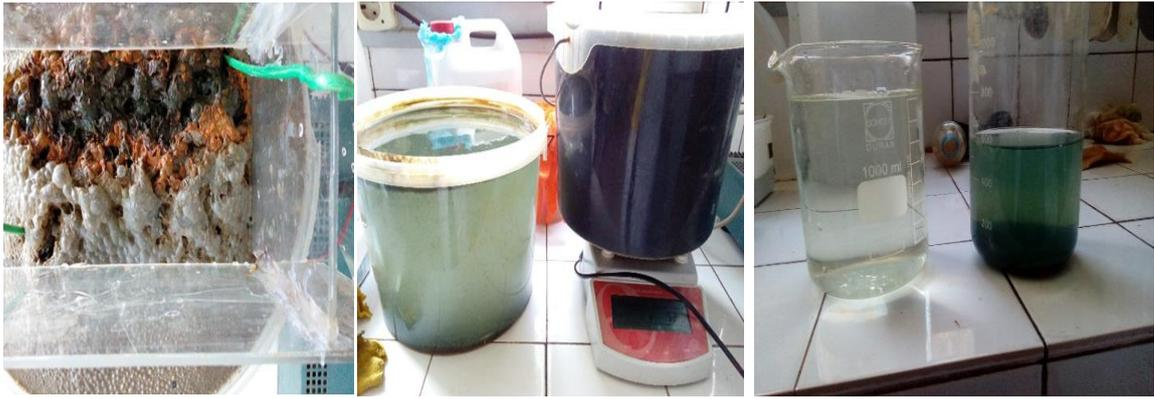
**Fig.14.** Etapes de la formation de mousse et de floccs au cours du traitement par le procédé d'électrocoagulation. (a) Flottation de mousse, (b) Décantation des floccs, (c) Filtration de l'eau traitée.
