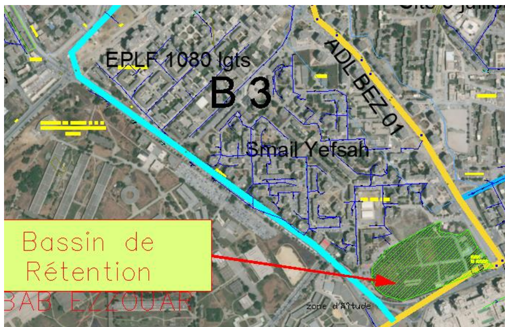
Figure V.16: Schéma descriptif du tracé de l'ouvrage collecteur Bab Ezzouar pour son tronçon de section (D).
