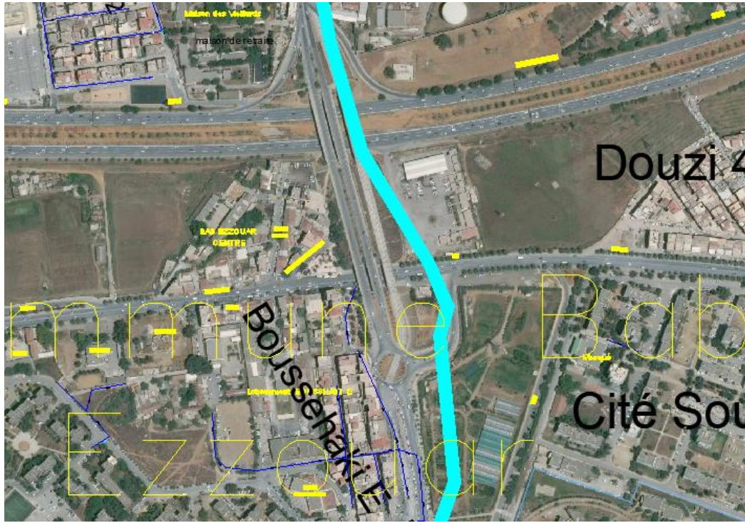
Figure V.15: Schéma descriptif du tracé de l'ouvrage collecteur Bab Ezzouar pour son tronçon de section (C) de diamètre Ø1600mm.
