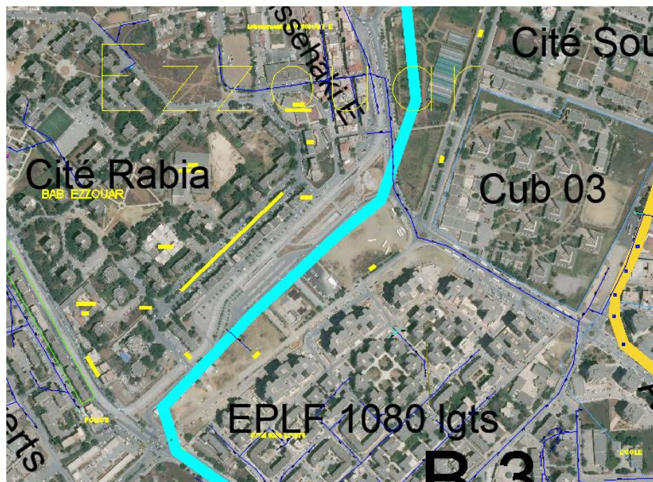
Figure V.16: Schéma descriptif du tracé de l'ouvrage collecteur Bab Ezzouar pour son tronçon de section (D).
