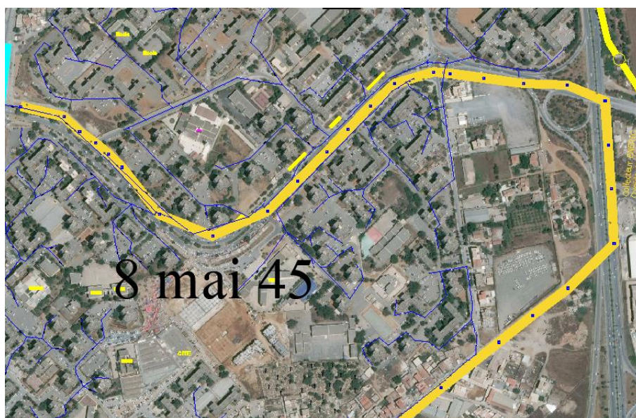
Figure V.2: Schéma descriptif du tracé de l'ouvrage ENRIC pour son tronçon de Section (A) au niveau du Boulevard principal de la cité 08 Mai 1945 (SORECAL).
