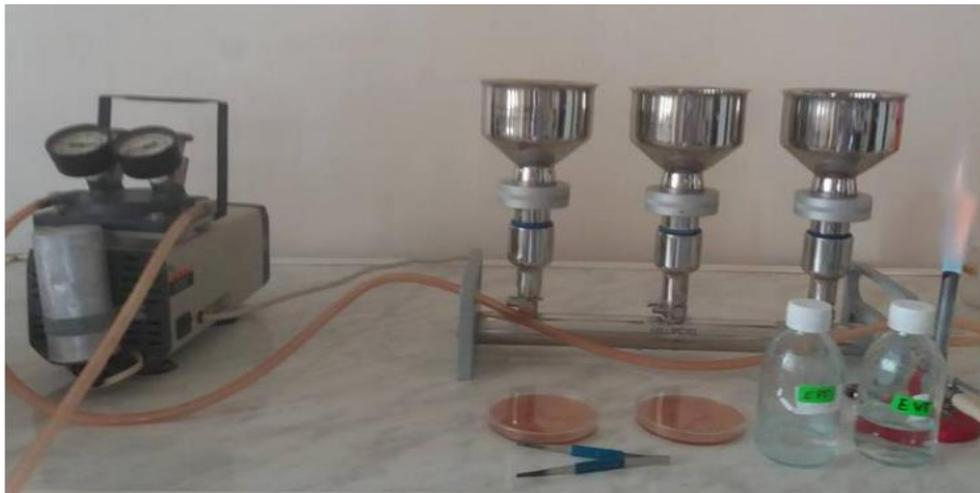
**Figure 06 :** Dispositif de filtration sur membrane (Photo 2023)
