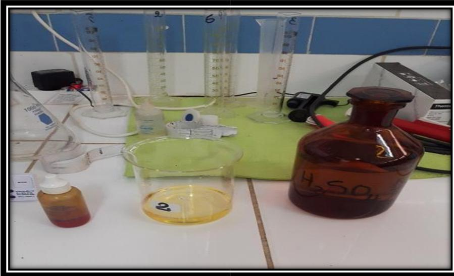
Figure 3.5 : Illustration de la méthode de détermination de l'alcalinité
