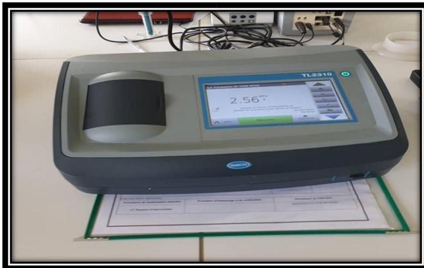
Figure 3.3 : Turbidimètre TL2310
