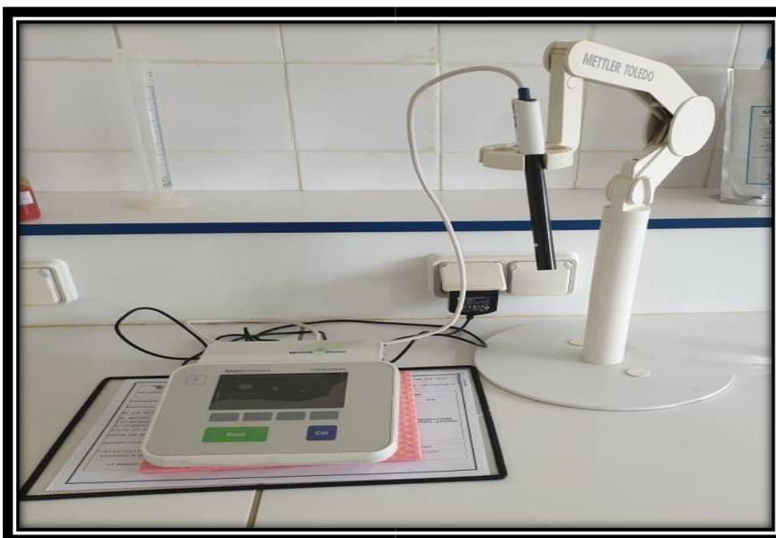
Figure 3.4 : Conductimètre
