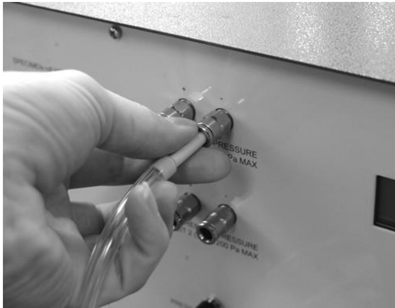
Figure III.8: Ajustez les adaptateurs de tube aux extrémités de la tuyauterie Afin qu'ils s'insèrent dans les orifices de pression
