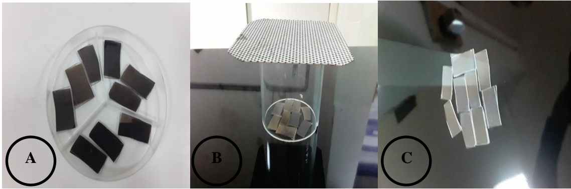
Figure 2.6. Traitement thermique : (A) avant le recuit, (B) au cours du recuit, (C) après recuit
