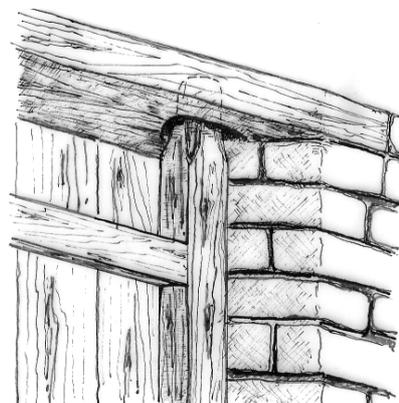
Figure n° 6.2.11.(1): Systèmes de rotation et de fermeture de portes d'entrées.
