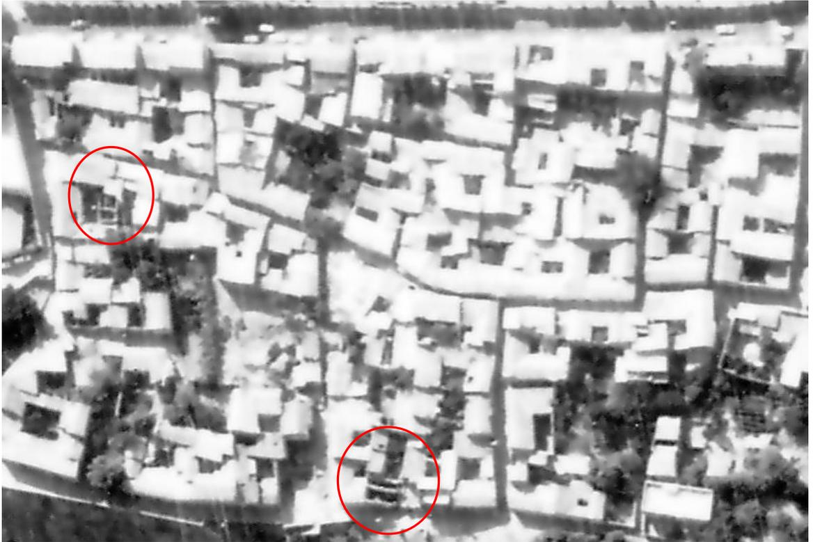
Vue aérienne de 1980 montrant l'état du bâti dans la basse casbah. Malgré un niveau appréciable de conservation, on peut signaler l'existence d'écroulements partiels (toitures et murs) qui préfigurent un processus de dégradation beaucoup plus ample.
