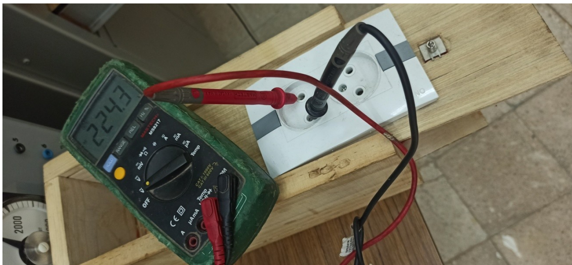
Figure III. 14 : La tension délivrée par notre onduleur.
