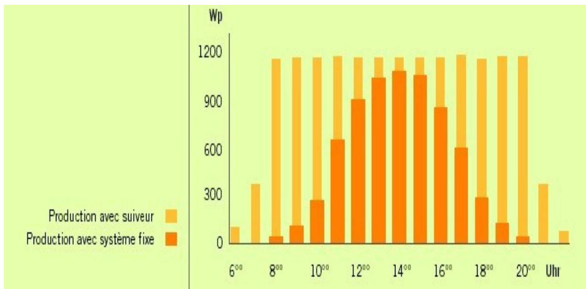
Figure II. 13: Diagramme de comparaison entre la production avec suiveur et la production avec système fixe.
