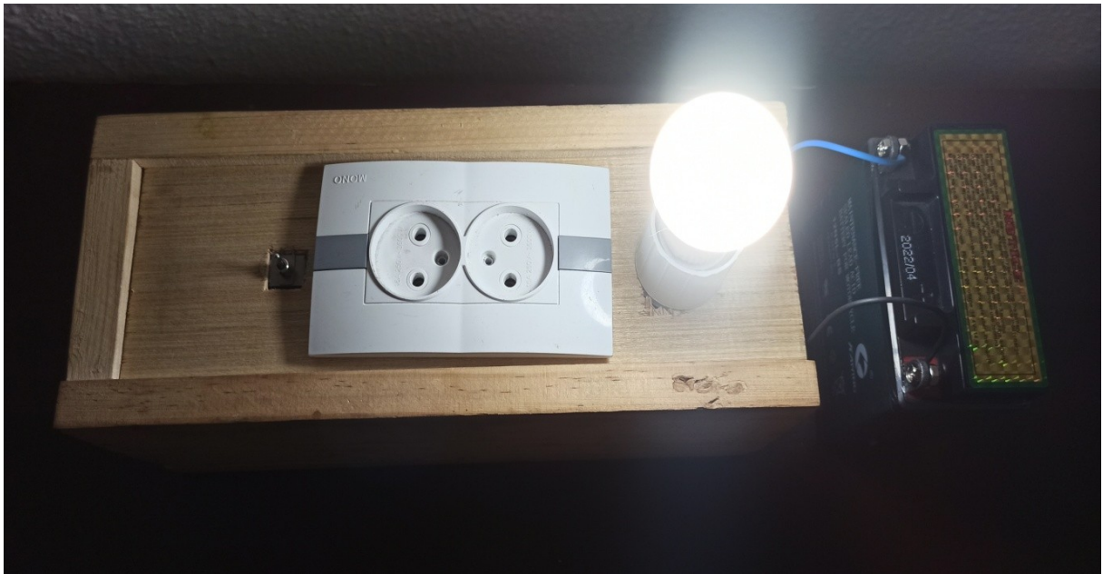
Figure III. 15 : Montage final de notre onduleur sous tension 12V.
