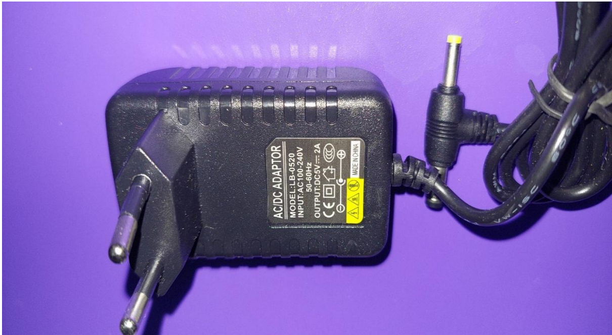
Figure : 2.4(a)-Photo réelle du transformateur
