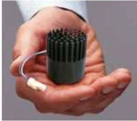
Figure 1.9 . Générateur thermoélectrique développé par la société PERPETUA.
