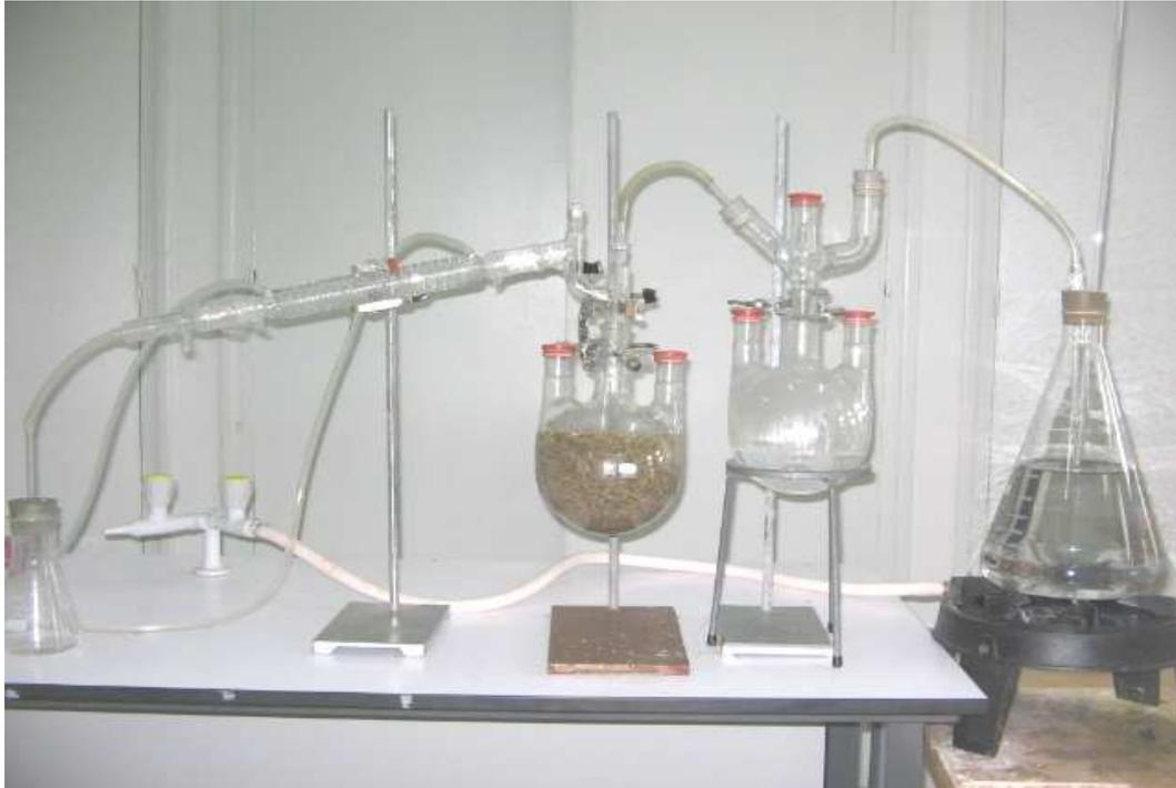
Figure: Dispositif d'extraction des huiles essentielles par entraînement à la vapeur
