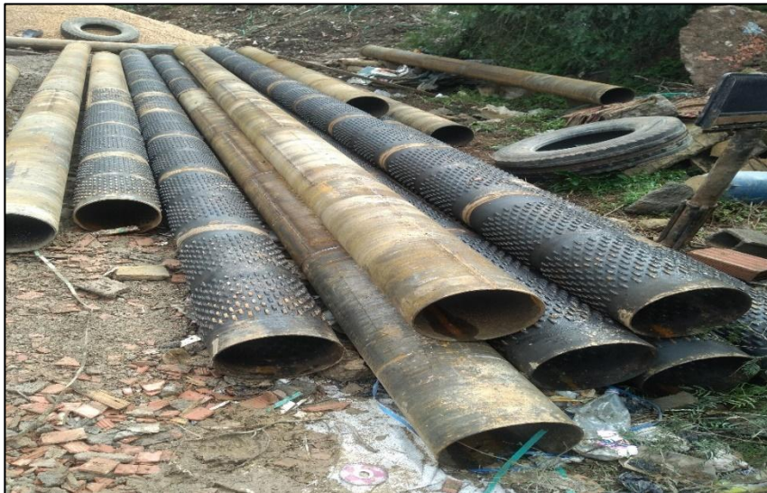
Figure IV-10 : photo de tube crépine et plein
