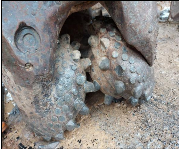
Figure IV-8 : photo de différents diamètres des outils de foration
