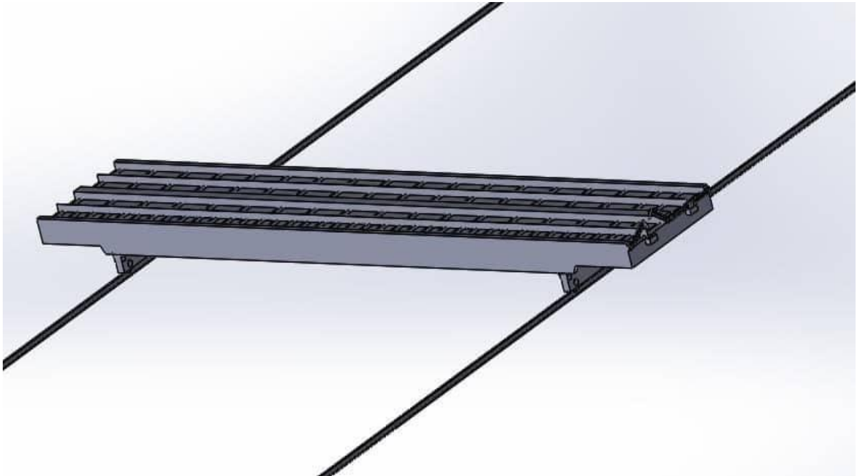
Figure IV11 : chariot de transfert sur rails dans SolidWorks
