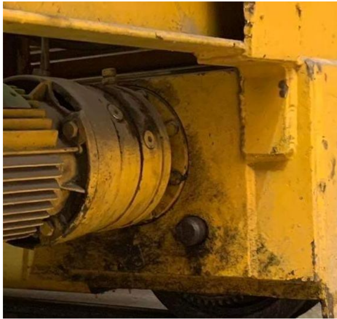
Figure III 6 : Réducteur mécanique monté sur chariot
