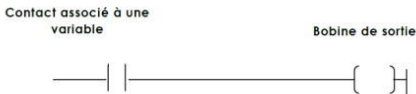
Figure 3-7 Programmation en langage à contact.[33].
