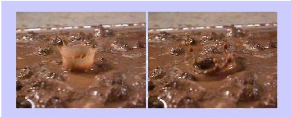
Photo I.2: Impact de la chute de la gouttelette d'eau sur le sol en réalité. (FOX D., 2008).
