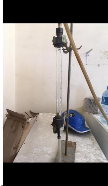
**Figure 4 :** rotamètre
