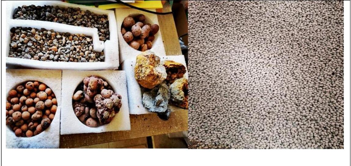
**Figure 1.4 :** Les différentes fractions d'argile expansée.
