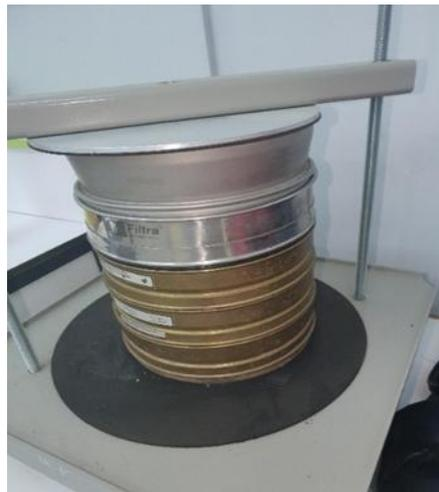
**Figure 4.3 :** Machine de tamisage
