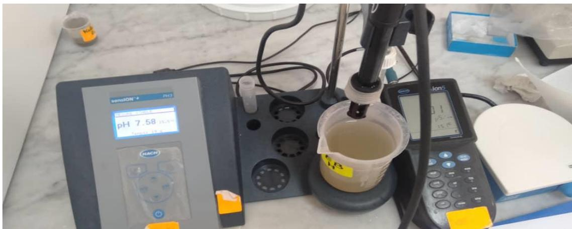
**Figure2.13** : PH-mètre (SENSION PH3)
