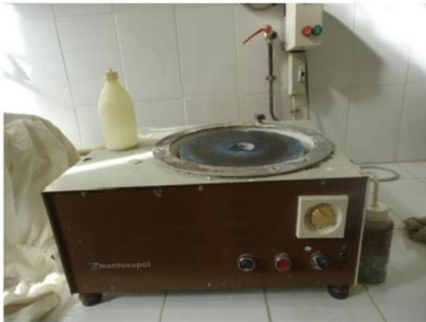
**Figure III.3** : polisseuse de finition
