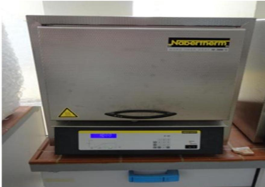
**Figure III .15** : four électrique modèle (NABERTHERM)
