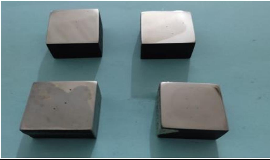
**Figure III.5** :L'échantillon préparé pour le microscope optique
