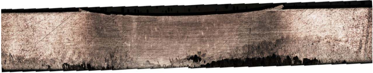
Figure 5-4 : Microstructure d'un joint soudé par FSW sans ajout du renfort Cr 2 AlC, avec une vitesse de rotation V_r= 1120 tr/min, et une vitesse d'avance V_a= 8 mm.
