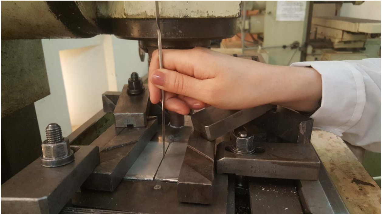
Figure 4-19 :estimation du vide entre les plaques.
