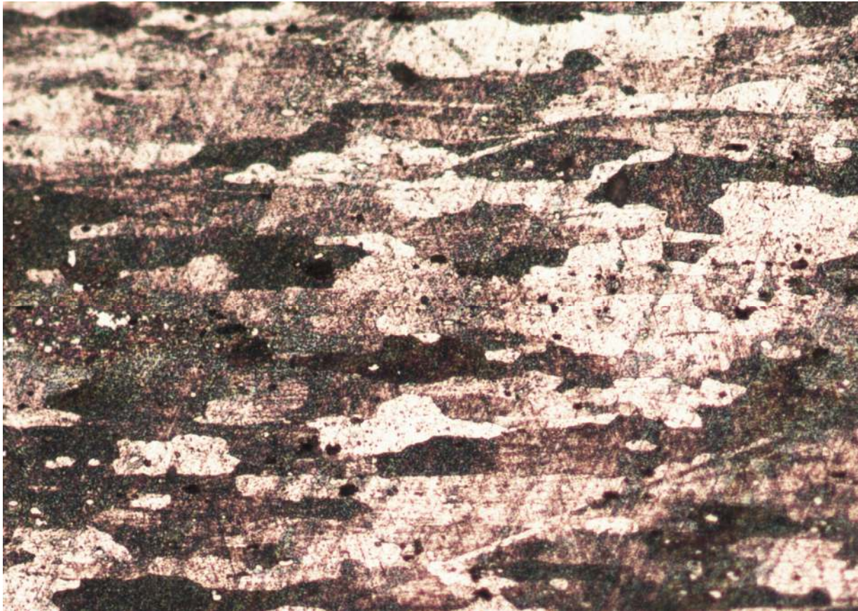
Figure 5-3: microstructure du métal de base 2024.
