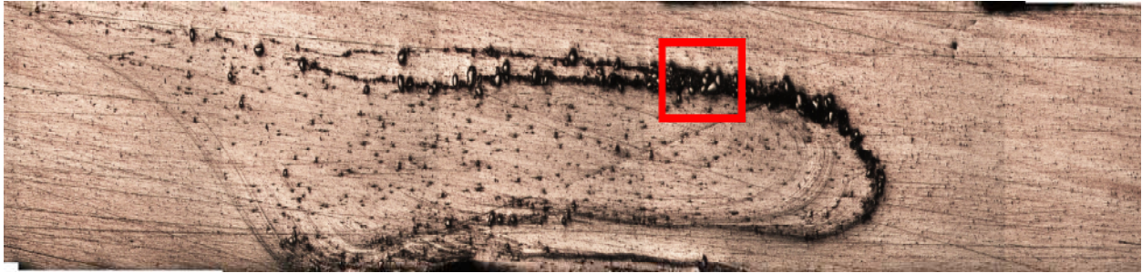
Figure 5-11 :Vue panoramique d'une microstructure d'un joint soudé par FSW avec ajout du renfort Cr 2 AlC, avec une vitesse de rotation V_r = 1120 tr/min, et une vitesse d'avance V_a = 8 mm.
