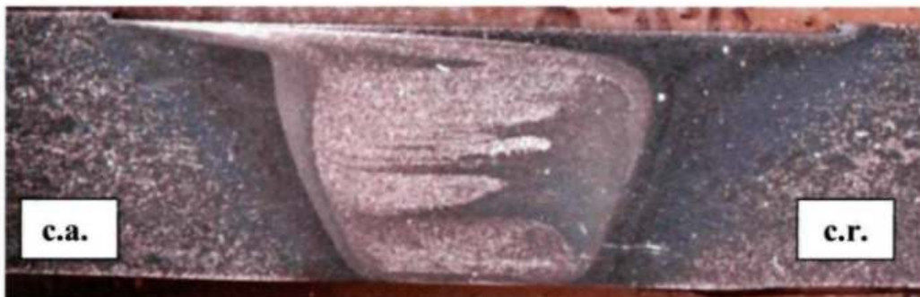
Figure 3-3 Métallographie démontrant l'asymétrie entre le côté avançant et le côté reculant
