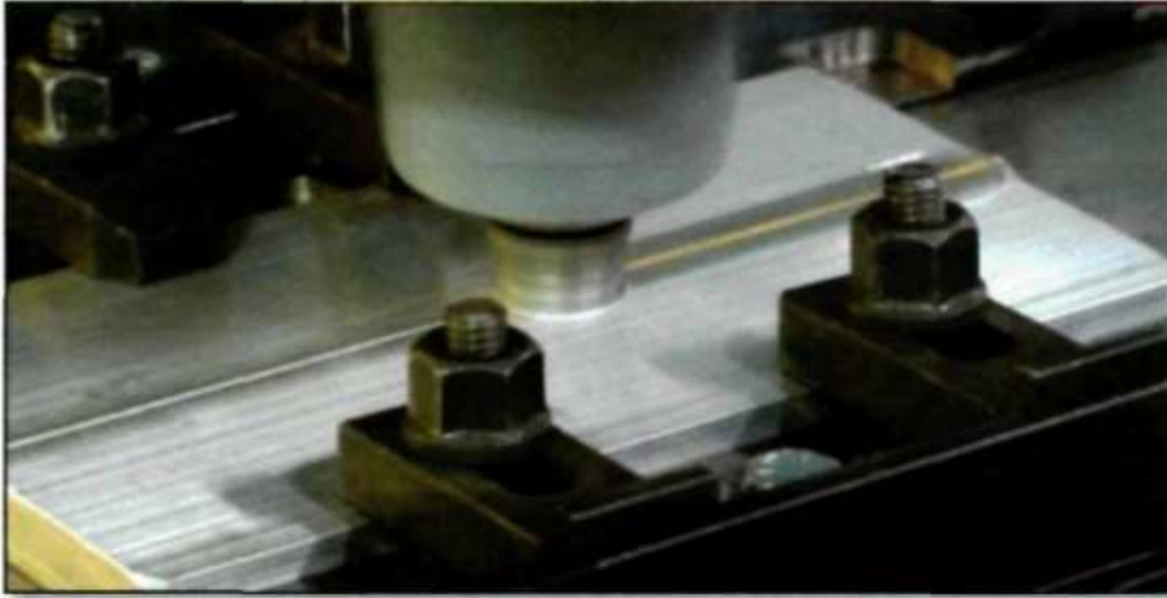
Figure 3-2 procédé de soudage sur le banc d'essai
