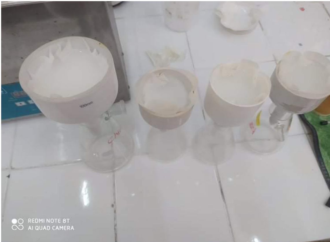
Figure 3-10 : filtration du mélange kaolin par le chlorure d'hydrogène (HCl).
