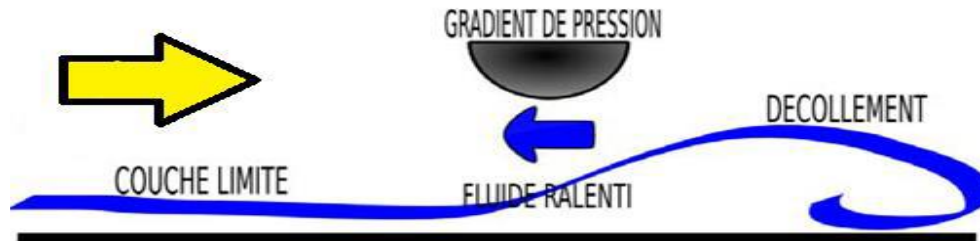
Figure. I.18 : Décollement de la couche limite.
