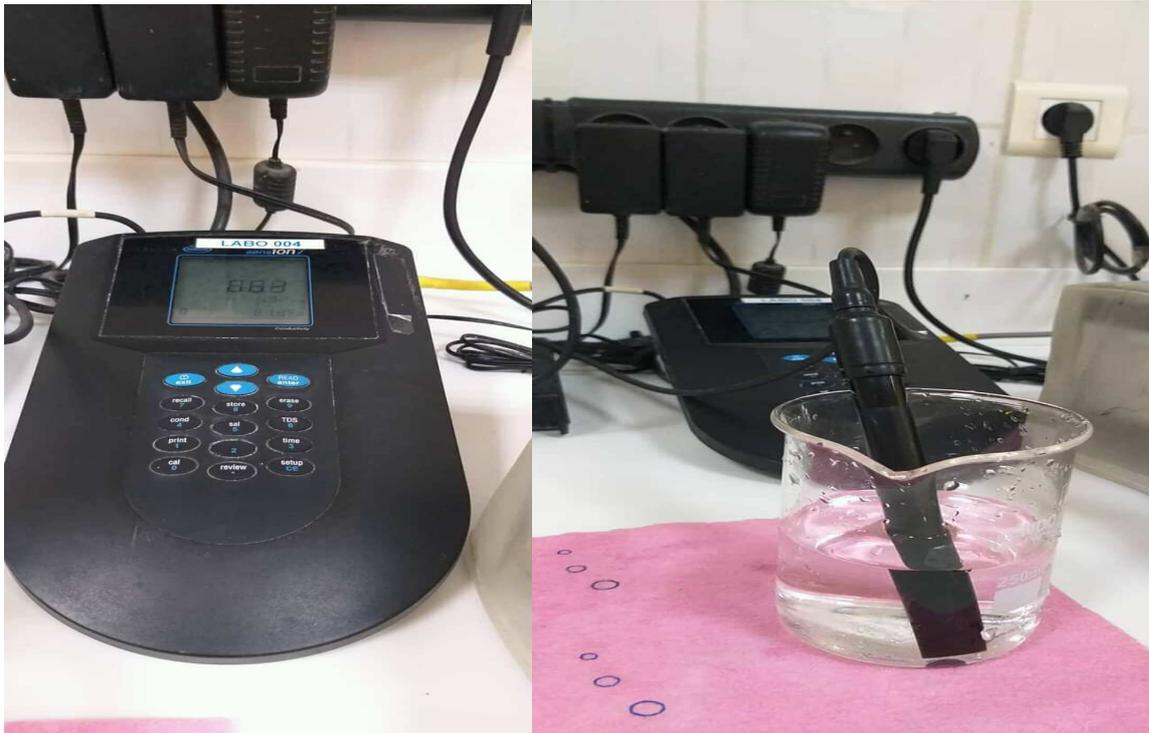
Figure III .4 : l'appareil conductimètre.
