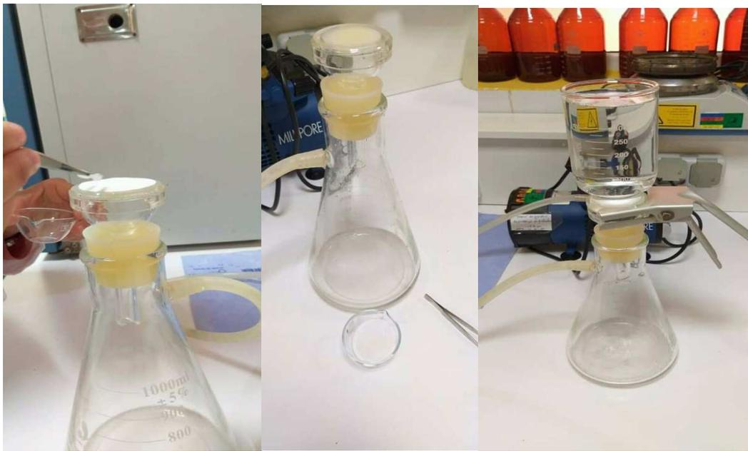
Figure III .6 : principe de détermination de MES
