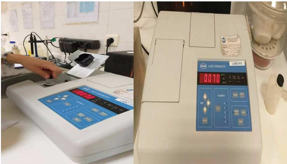
Figure III .3 : l'appareil turbidimètre.
