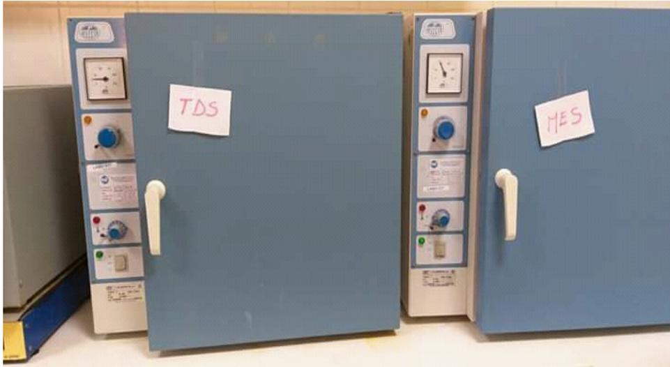
**Figure F** : étuves de séchage pour les mesures de TDS et MES.
