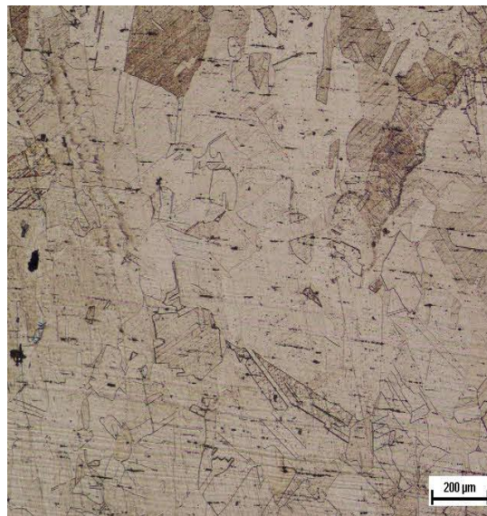
Figure4.12: Microstructure de métal de base (316) avec un grossissement de X50.
