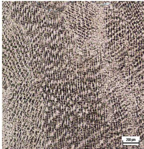
Figure4.15: Microstructure du ZF(316) avec un grossissement de X50.
