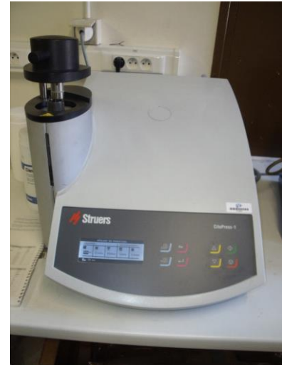
Figure3.2 : Machine enrobeuse et les échantillons enrobées par la résine.
