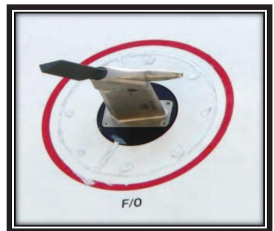
Figure IV.33 : Le schéma du système de Pitot-statique
