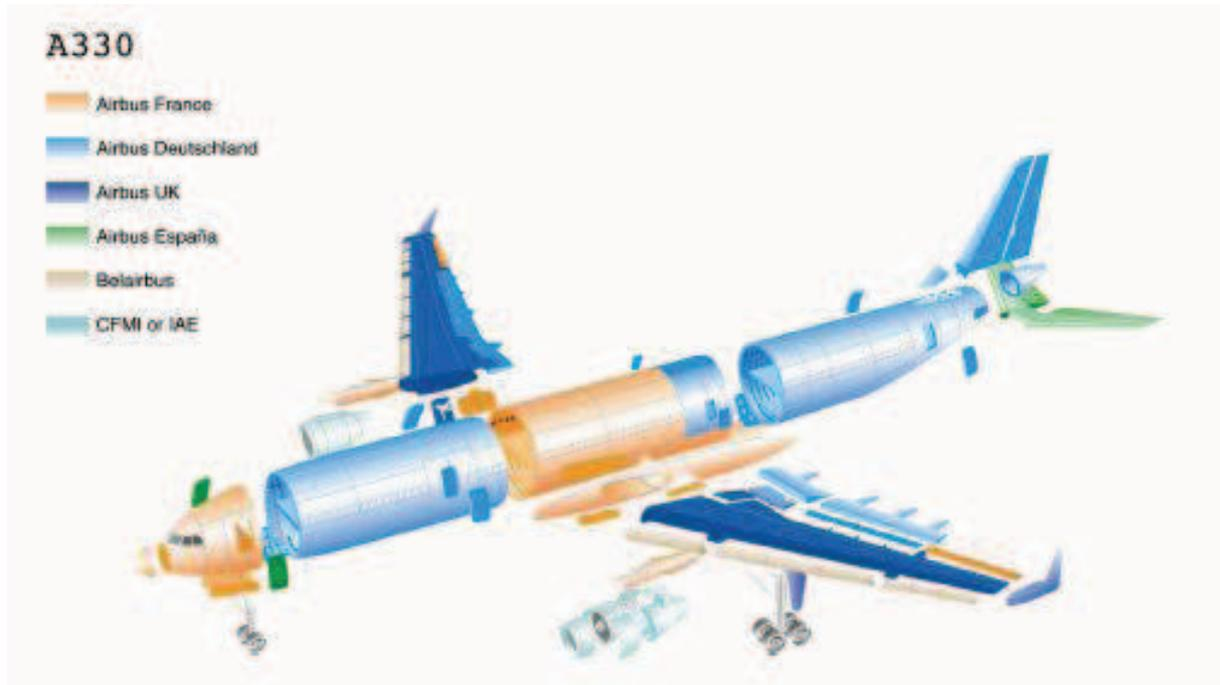
**Figure I.1 : Répartition industrielle de l'Airbus A330**
