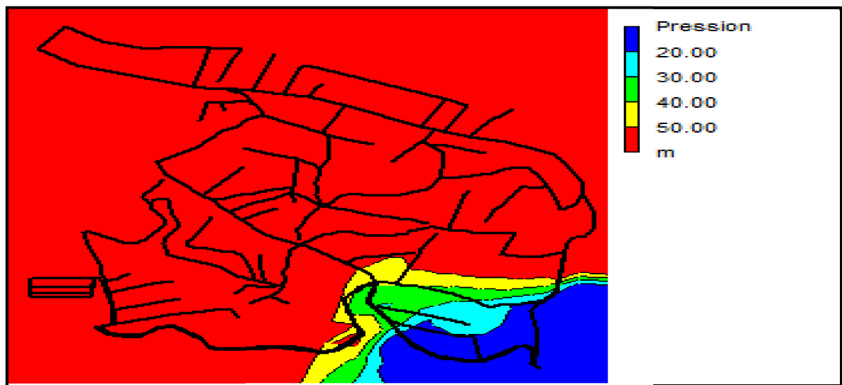
Figure (V.6) : Etat des pressions pendant la période de pointe et incendie .
