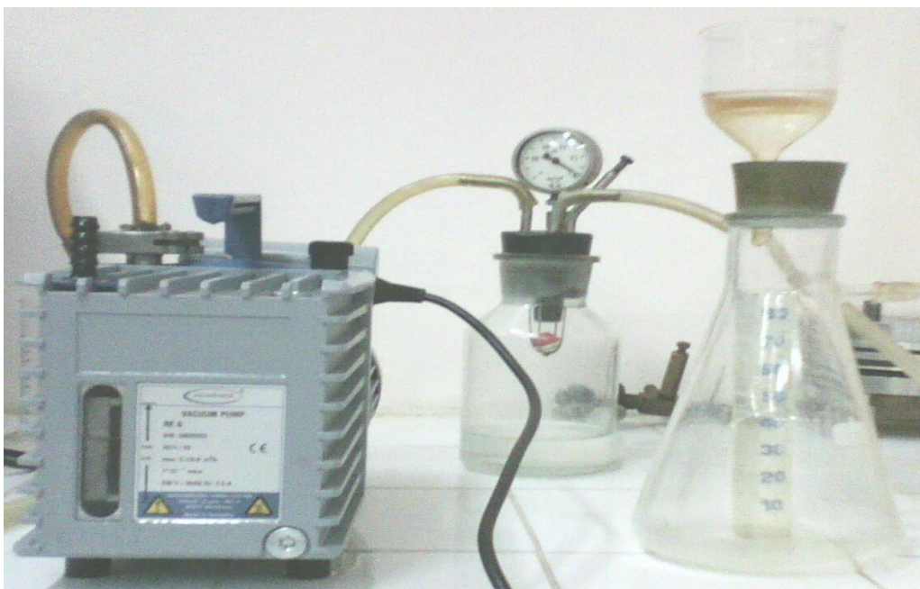
Figure III-3 : Photo du dispositif de filtration.
