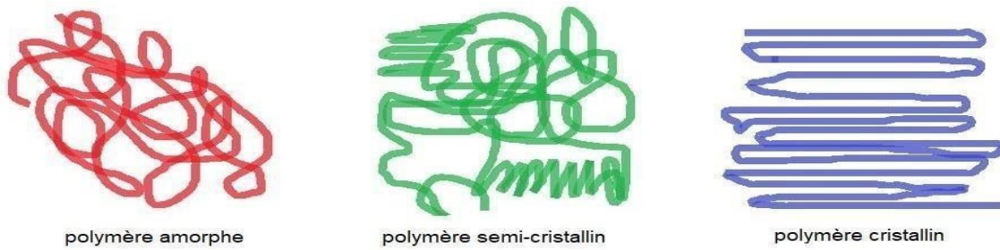
Figure 1 : dessin qui résumé les structures des polymères [4]
