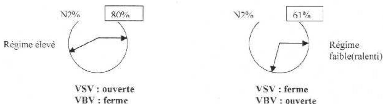
Les vérins de VBV actionnent les portiers VBV à une position OUVERTE quand les stators à calage variable (VSV) sont actionnés à la position FERME, c.à.d quand la vitesse de rotation N2 atteint les 61% de sa vitesse maximale (au bas régime)
