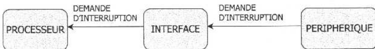
Fig III.3 transfert d'une demande d'interruption du périphérique au processeur
