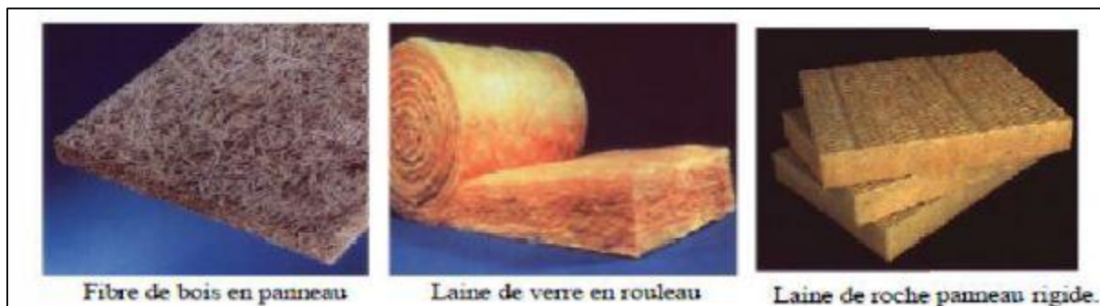
Figure 31 : matériaux isolants /source : isolation thermique à température ambiante. Propriétés. Techniques de l'ingénieur. Document n° 3371.france.
