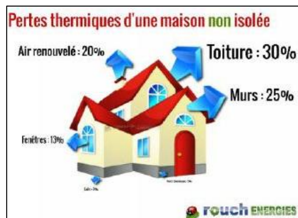
Figure 28: Répartition moyenne des déperditions d'une maison non isolée /source :devismaison.tk.
