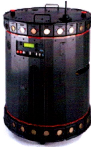
Fig.2. 9 : Robot mobile omnidirectionnel Nomadic XR4000
