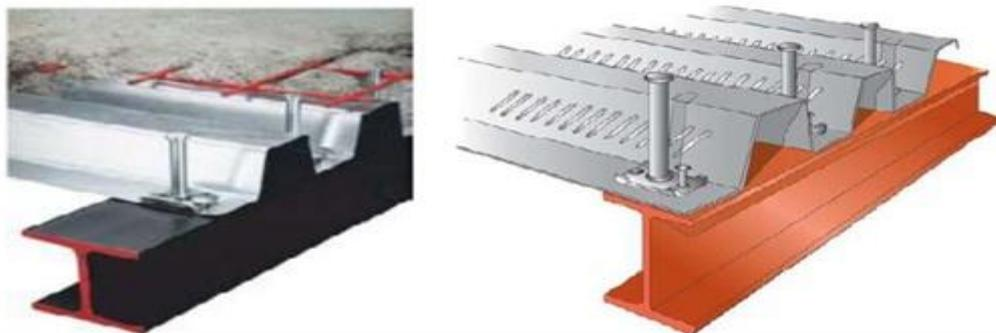
**Figure I. 2:** Connecteur de type Nelson (goujon à tête).
