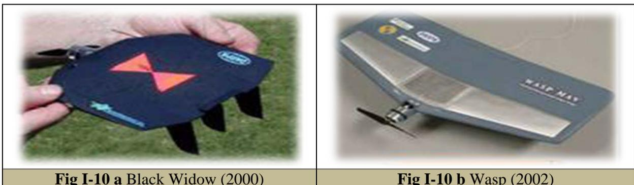
Aerovironment mit au point un autre micro-drone en 2002, le "Wasp" (Fig. I. 10.b.), qui réussit à voler durant 1 h 47 min, record absolu pour un engin de 32 cm d'envergure et
